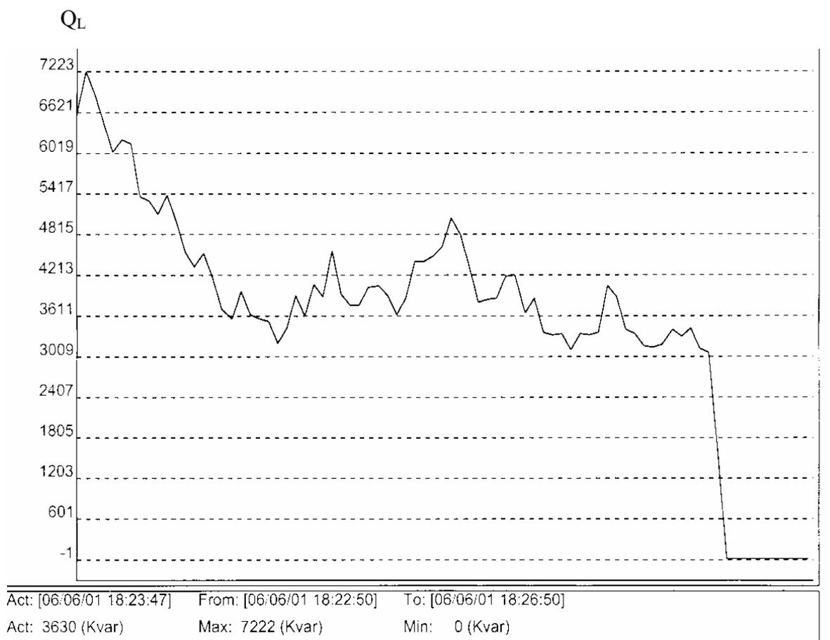
Рис.6 Изменение реактивной мощности ДСП-50 в рабочих режимах.
