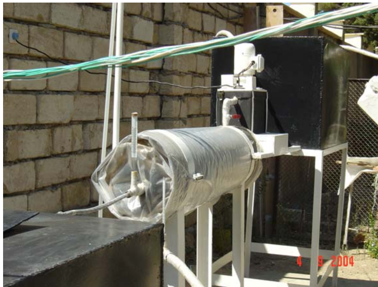
Şəkil 2 (a,b) Parabolosilindrik konsentratorlu günəş energetik qurğusu.
