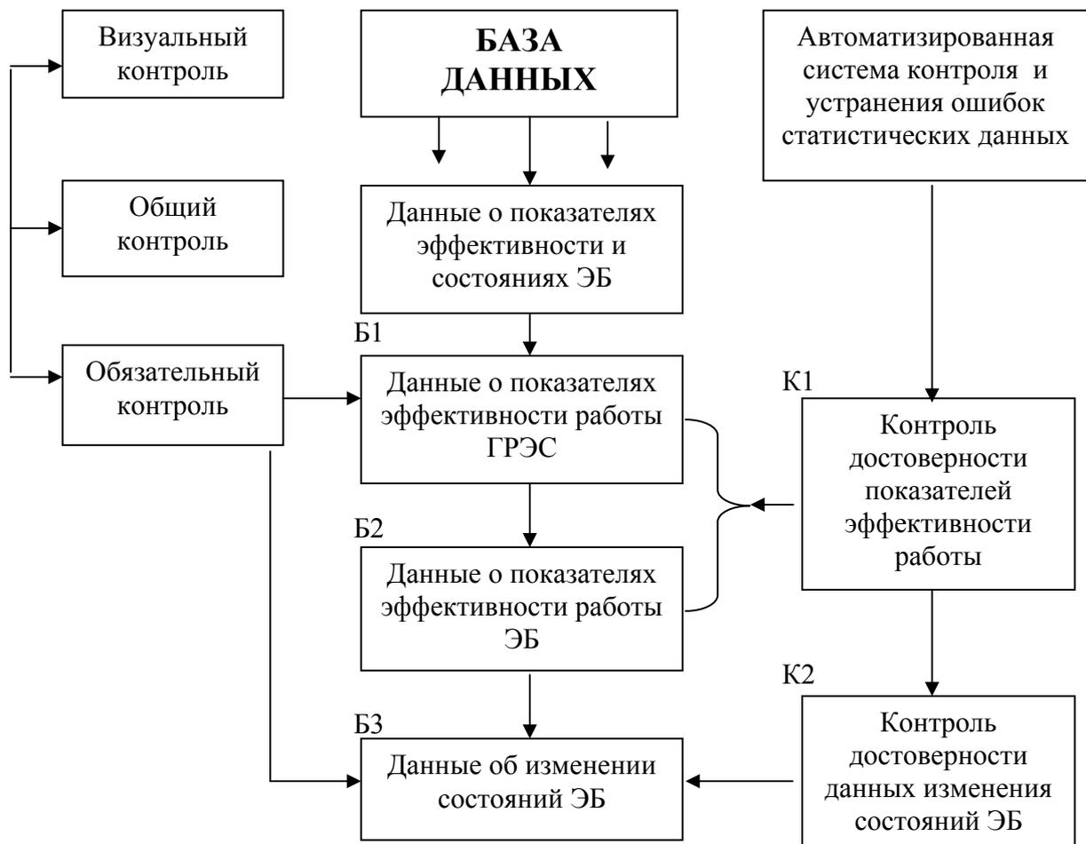
Рис.2. Структурная схема контроля достоверности данных.
