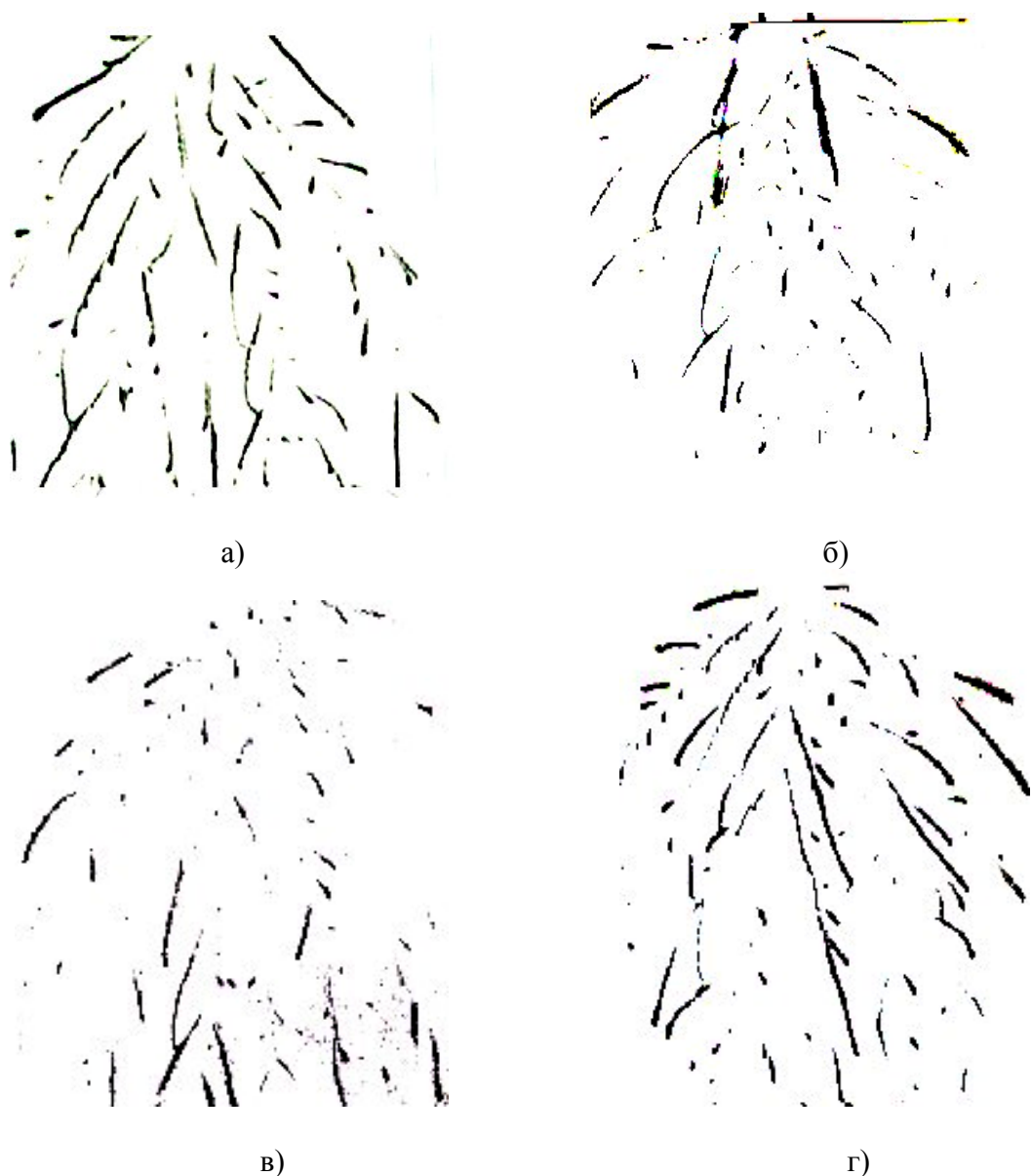
Рис 5. Электрограммы разряда для промежутка игла плоскость: а – ситалл (0,5 мм), б – ситалл (1 мм), в – керамика (1 мм), г – поликор (1 мм).
