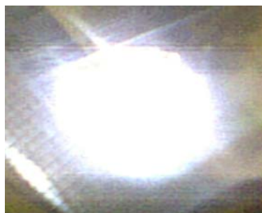
Рис. 7. Катод – металлический стержень r_k=1 мм, анод – металлическая сетка, U_{ГЕН}=100 кВ, P=3,8 атм., межэлектродное расстояние d=10 мм
