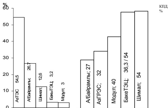
Рис1. Коэффициент полезного действия и объем производства электроэнергии тепловыми электростанциями в 2007 году.(КПД Баку ТЭЦ1-в режиме комбинированного цикла составляет порядка 54%, а в режиме байпаса 36,3%)
