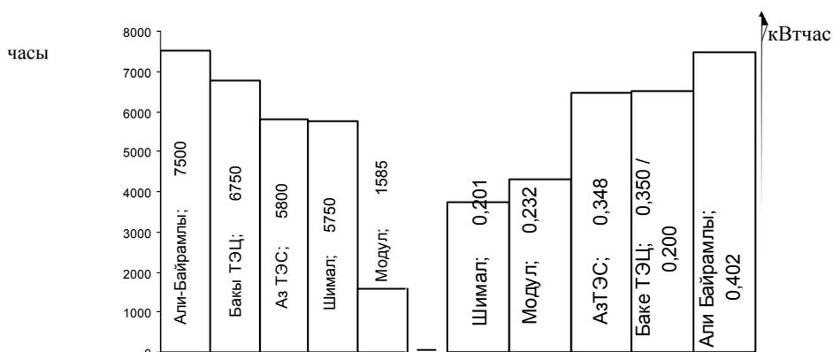
Рис. 2. Средний расход природного газа на производство электроэнергии (м³/кВтчас) и примерное число часов использования максимума мощности тепловых электростанций
