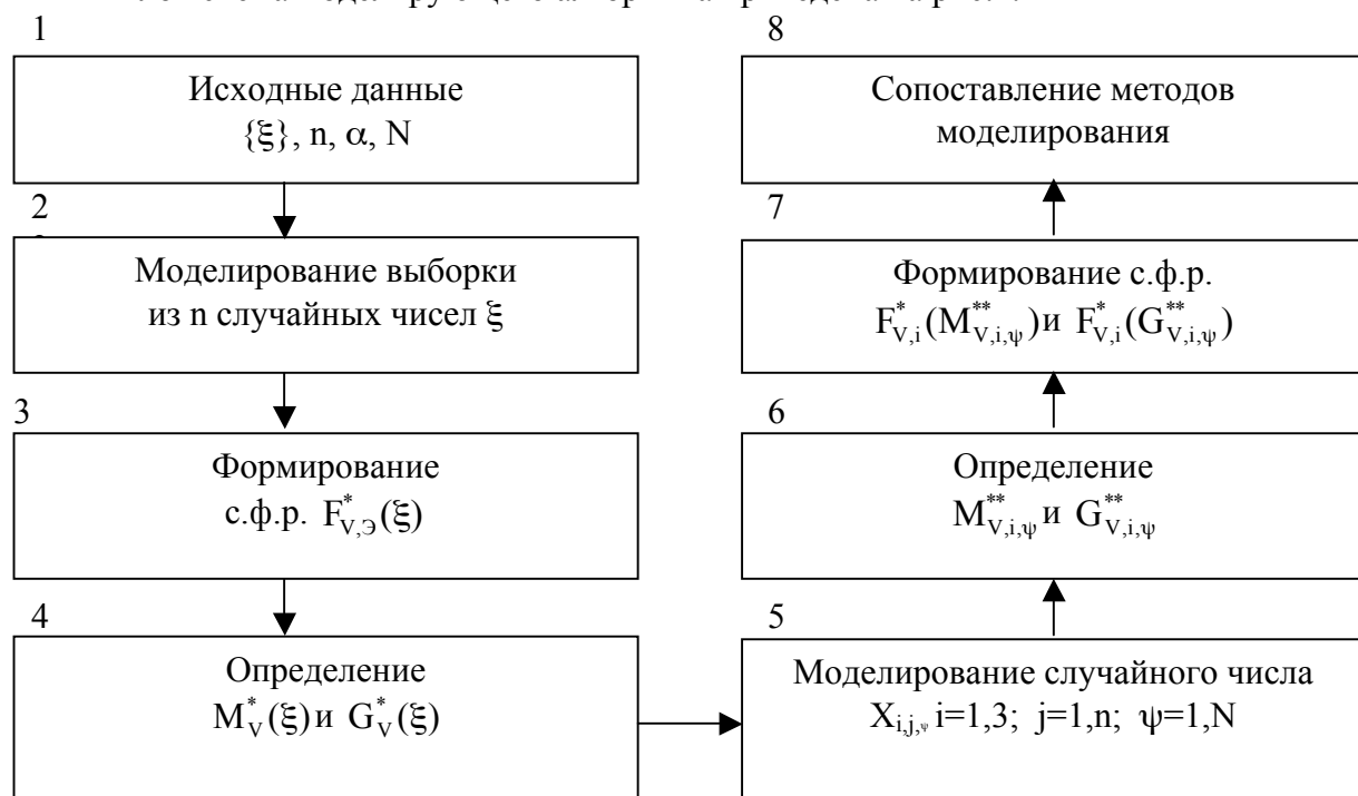
Рис 2. Укрупненная блок-схема алгоритма сопоставления методов моделирования непрерывных случайных чисел
