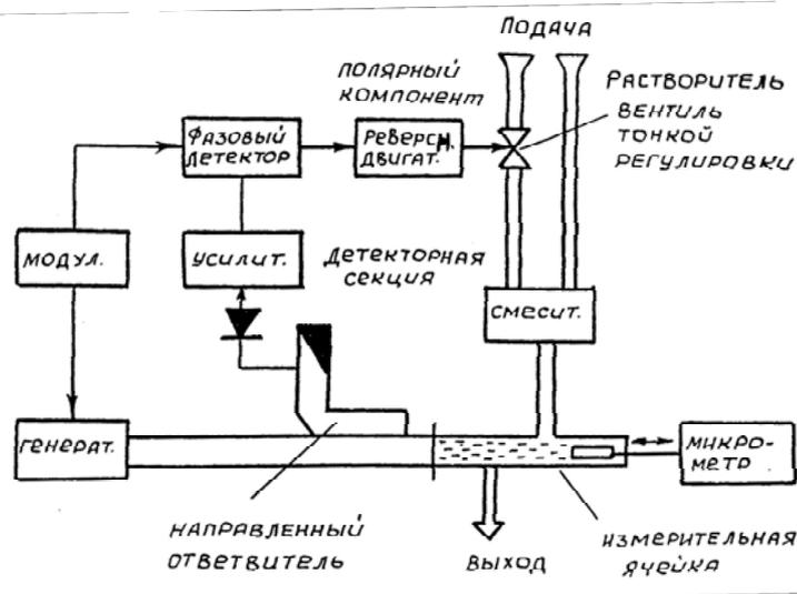
волноводную измерительную ячейку проточного типа и направленный ответвитель с детекторной секцией для выделения излучения, отраженного от ячейки с анализирующим раствором (Рис.1).
