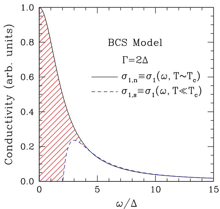
Рис. 5-16 Действительная часть оптической проводимости металла в нормальном и сверхпроводящем состоянии, с учетом конечной частоты рассеяния на примесях  $\Gamma = \frac{1}{\tau} = 2\Delta$ .
