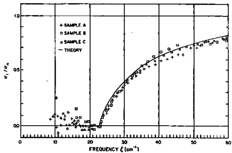
Рис. 5-15 Действительная часть оптической проводимости свинца в сверхпроводящем состоянии при  $T = 2\text{K}$  (L.Palmer, M.Tinkham, 1968).
