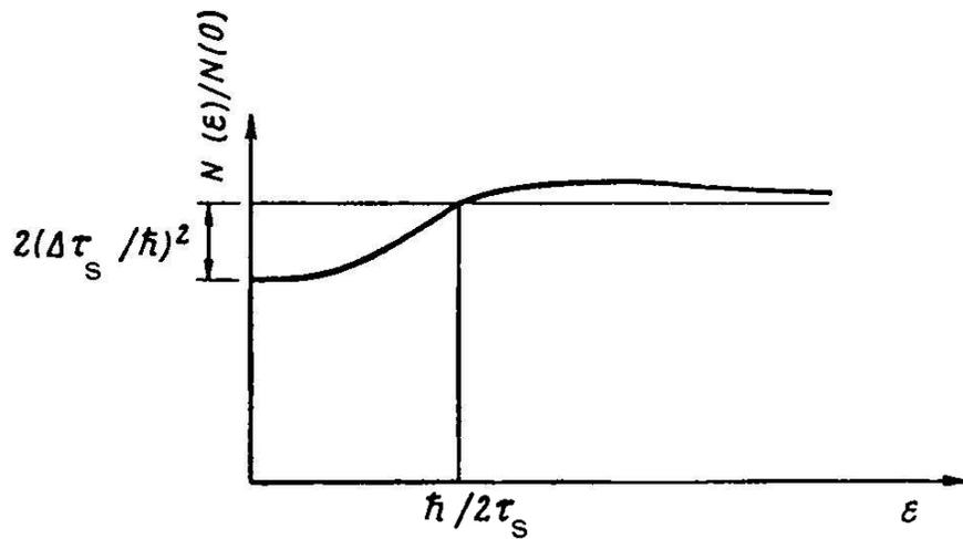
Рис. 5-10 Плотность электронных состояний в бесщелевом сверхпроводнике.
