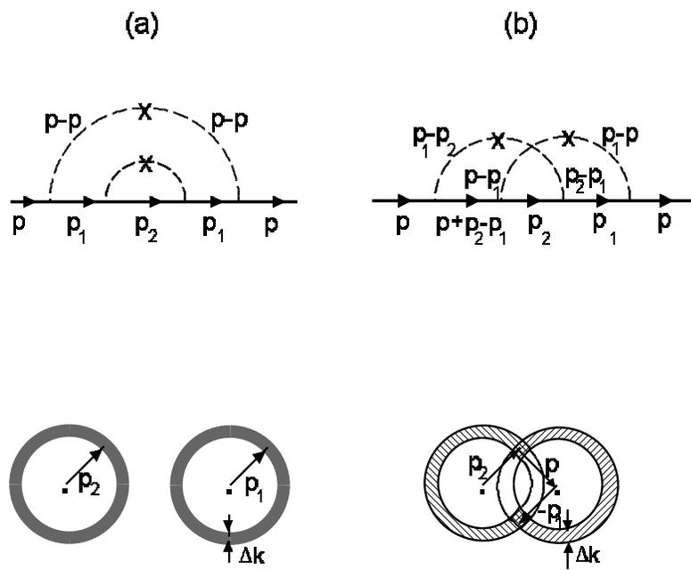
Рис. 4-8 Диаграмма без пересечения линий взаимодействия (а) и с “перекрестами” (b). Показаны также соответствующие области интегрирования в импульсном пространстве.
