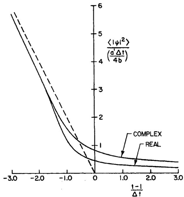
Рис. 6-17 Температурное поведение среднеквадратичной флуктуации параметра порядка в одномерной модели ГЛ. Показаны случаи действительного и комплексного параметров порядка. Пунктир — результат приближения самосогласованного поля для квадрата параметра порядка.
