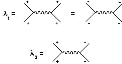
Рис. 6-35 Взаимодействия частиц в модели Томонага – Латтинжера.
