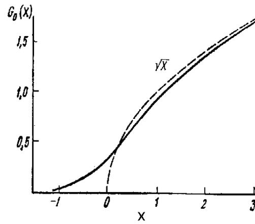
Рис. 4-10 Функция  $G(x)$ , определяющая плотность состояний в модели Келдыша.
