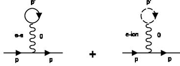
Рис. 2-9 Простейшие хартриевские диаграммы, описывающие взаимодействие электронов между собой и с положительным “фоном” ионов (функция Грина ионов показана пунктиром).
