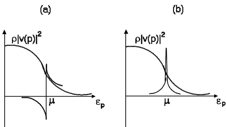
Рис. 4-6 (а) – сравнение  $\rho|v(p)|^2$  и функции  $\frac{\epsilon - \epsilon_p + \mu}{(\epsilon - \epsilon_p + \mu)^2 + \delta^2}$ , входящей в  $Re\Sigma^{1BA}(p\epsilon)$ .
