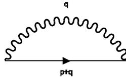
Рис. 2-10 Собственно – энергетическая часть электрона в RPA приближении. “Самодействие” посредством экранированного кулоновского взаимодействия.
