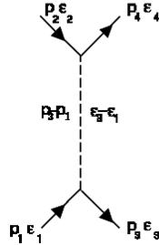
Рис. 5-1 Элементарный процесс взаимодействия двух электронов посредством обмена фононом.
