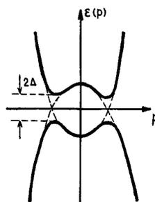
Рис. 6-14 Электронный спектр экситонного изолятора в модели с прямым перекрытием электронной и дырочной зон.
