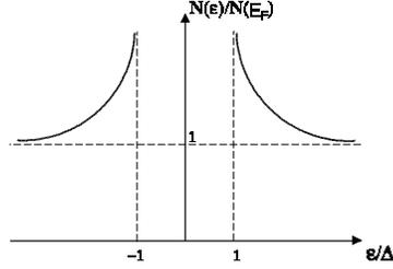
Рис. 6-9 Плотность электронных состояний БКШ – типа в пайерлсовском диэлектрике.
