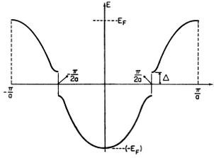
Рис. 6-8 Спектр электронов в пайерлсовском диэлектрике в случае исходного спектра модели сильной связи, для случая удвоения периода.
