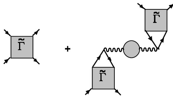
Рис. 2-21 Общая структура полной вершинной части в задаче с кулоновским взаимодействием.
