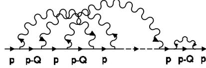
Рис. 6-21 График произвольного порядка для одноэлектронной функции Грина.
