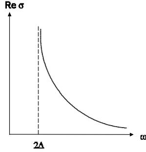
Рис. 6-30 Частотная зависимость действительной части проводимости в пайерлсовском диэлектрике.
