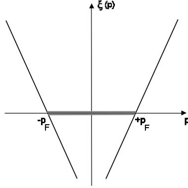
Рис. 6-3 Линеаризованный (вблизи уровня Ферми) спектр электронов в одномерном металле. “Поверхность” Ферми представляет собой прямую линию, заполнены электронные состояния в области  $(-p_F, p_F)$ , которая заштрихована.
