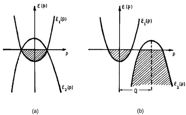
Рис. 6-13 Электронный спектр исходного полуметалла в модели экситонного изолятора: (а) – прямое перекрытие зон, (б) – общий случай, экстремумы перекрывающихся зон раздвинуты на вектор  $Q$ .
