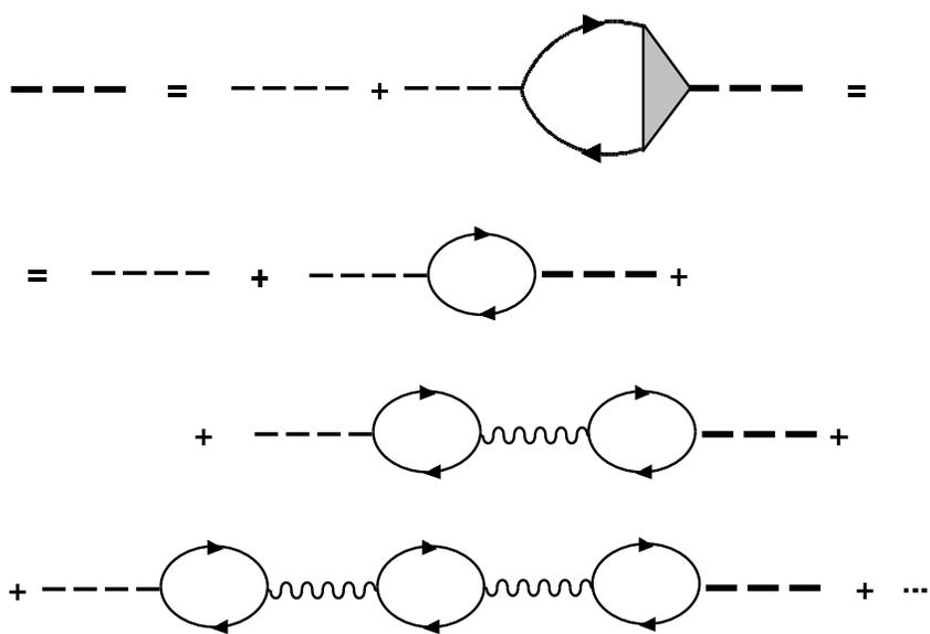
Рис. 3-11 Уравнение Дайсона для фоновной функции Грина в обобщенной модели желе.
