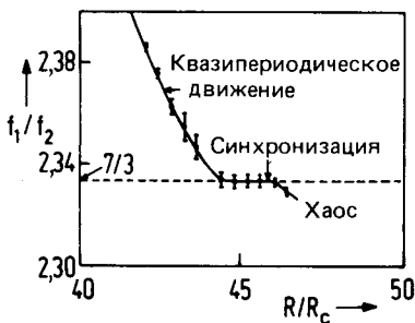
Рис. 83. Синхронизация частот в эксперименте Бенара (Gollub, Benson, 1979).
