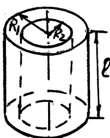
длины  $l$ , но с числом витков  $N_2$  и площадью сечения  $S_2$  ( $l \gg \sqrt{S_1}, \sqrt{S_2}$ ). Края соленоидов совпадают. Обмотки соединены последовательно так, что токи в обоих соленоидах текут в одинаковых направлениях. Пренебрегая индуктивностью, возникающей из-за присутствия провода, соединяющего оба соленоида, найти индуктивность системы:
