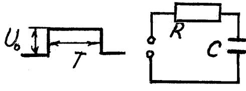
противления  $R$  и емкости  $C$ , прикладывается прямоугольный импульс напряжения:
