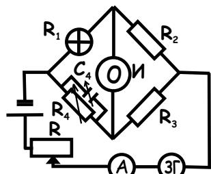
накаливания) модуляционным методом используется мост переменного тока, в одно из плеч которого вставлен испытуемый образец  $R_1$ , а в другое для уравновешивания амплитуды и фазы - сопротивление  $R_4$  и шунтирующая его емкость  $C_4$ . Ток, питающий мост, равен  $J = J_0 + J_1 \sin \omega t$ ,
