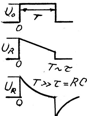
Из рисунков видно, что если длительность импульса много больше постоянной времени цепочки  $\tau = RC$ , т.е.  $T \gg RC$ , зарядка и разрядка конденсатора происходят очень быстро по сравнению с  $T$  и, значит, ток через сопротивление отличен от нуля в течение небольшого времени  $\tau$  в начале и конце импульса, а напряжение на сопротивлении пропорционально производной от прямоугольного импульса.
