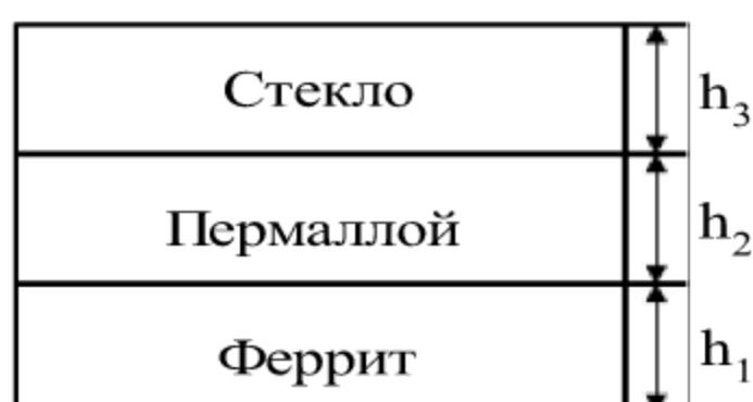
Рис. 2.16. Модель тройного соединения
