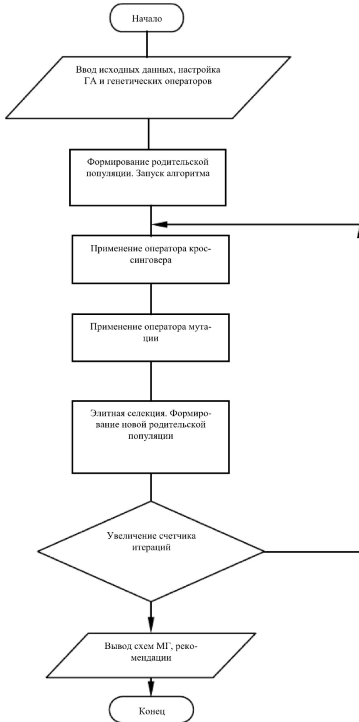
Рис. 3.14. Структурная схема разработанного ГА
