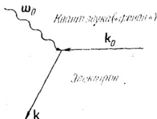
Рис. 7. Электрическое сопротивление в решетке без дефектов возникает благодаря «соударениям» электронов (прямые линии) с квантами звука (волнистая линия). На этом рисунке показан процесс поглощения кванта звука.
