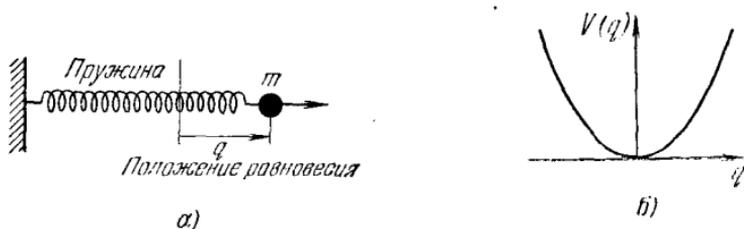
Рис. 10. Гармонический осциллятор: а) пример из механики; б) потенциальная энергия как функция отклонения.
