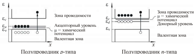
Рис. 1.77. Положение химического потенциала на энергетических диаграммах для изолированных полупроводников p -типа и n -типа
