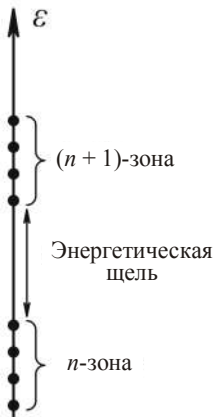
Рис. 1.10. Схема разрешенных значений энергии \varepsilon_n(k)
