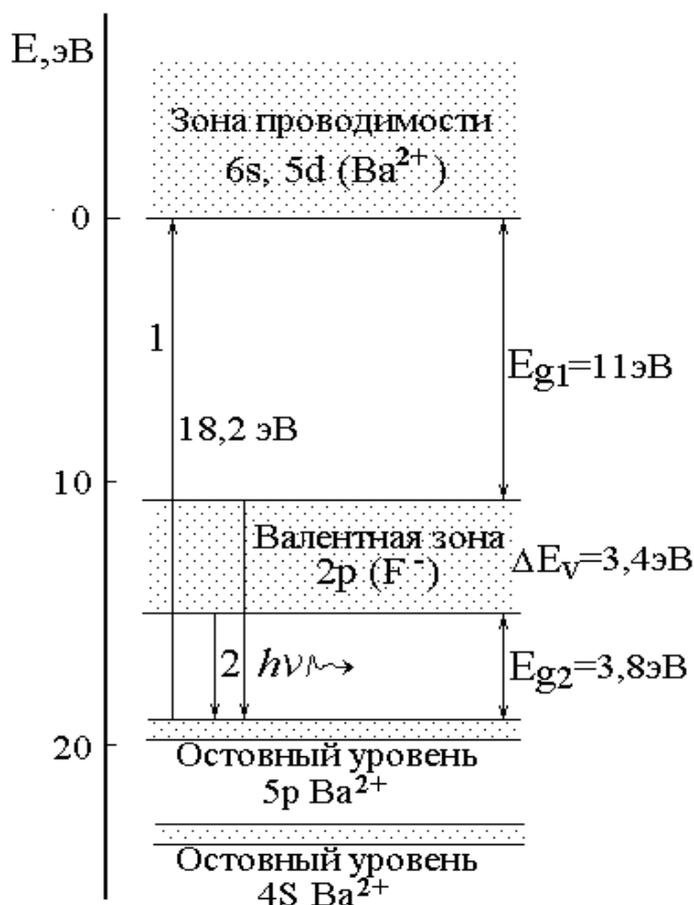
Рис. 7.3. Зонная схема кристалла BaF<sub>2</sub>, поясняющая механизм формирования излучательных междузонных переходов в оптическом диапазоне (кросс-люминесценции)
