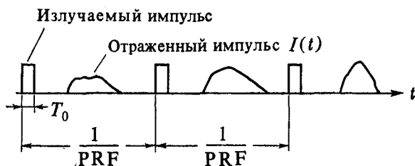
Рис. 5.5. Излучаемый сигнал в виде последовательности импульсов с периодом повторения (PRF)^{-1} , где PRF — частота повторения импульсов. Форма отраженных импульсов медленно меняется от импульса к импульсу.
