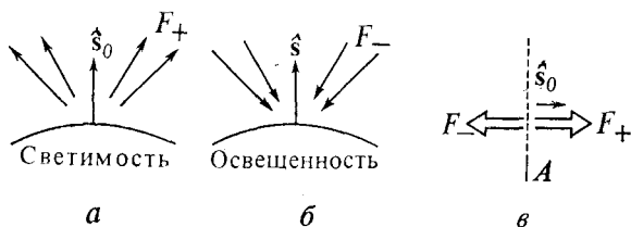
Рис. 7.5. Энергетическая светимость F_+ и освещенность F_- .
