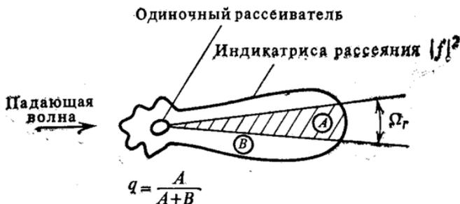
Рис. 14.14. Часть рассеянной мощности, даваемая множителем  $q$  в (14.73).
