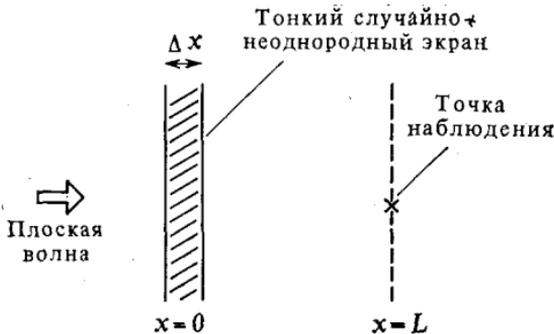
Рис. 20.8. Геометрия задачи о тонком (фазовом) экране.
