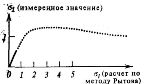
Рис. 20.10. Зависимость измеренной дисперсии флуктуаций интенсивности от значения дисперсии, вычисленного по методу Рытова.
