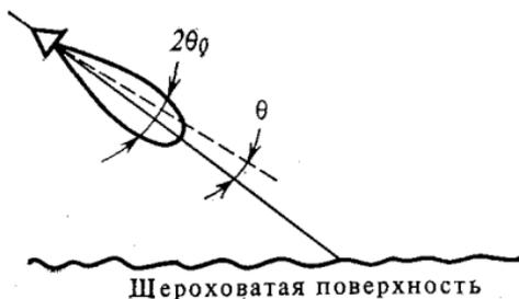
Рис. 21.8. Обратное рассеяние от шероховатой поверхности при освещении ее остронаправленным пучком.
