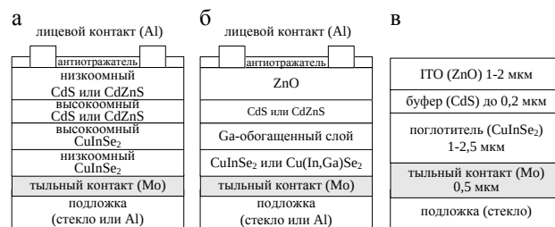
Рис. 38. Структура СЭ на основе трехкомпонентных соединений меди: а – с оптическим окном CdS и антиотражателем ; б – с оптическим окном ZnO и антиотражателем; в – с прозрачным лицевым электродом
