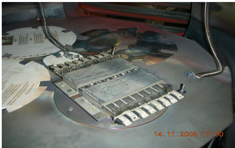
Рисунок 20 - Фото устройства нагрева держателя подложек
