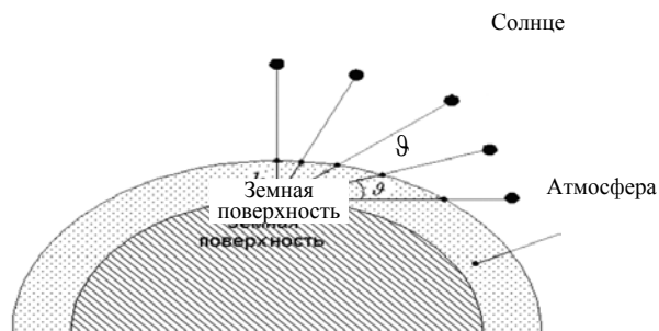
Рис. 13. Расстояние, проходимое в атмосфере солнечными лучами при различных положениях Солнца над горизонтом
