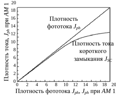
Рис. 30. Зависимость плотности тока короткого замыкания от плотности фототока [71]
