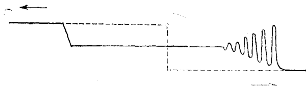
Рис. 15. Образование волны сжатия и волны разрежения при распаде начального разрыва.
