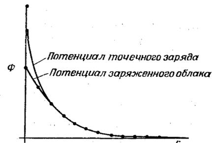
Фиг. 6.1. Сравнение потенциала точечного заряда в непрерывном пространстве с потенциалом заряженного облака, отвечающего частице на разностной сетке.
