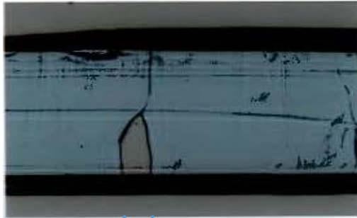
Şəkil 5. K_{0,945}Cs_{0,055}NO_3 kristalının II-modifikasiyası daxilində III-modifikasiya kristalı rüşeymini yaranması və böyüməsinə əks etdirən mikrofotografiya. Böyütmə x90 dəfə
