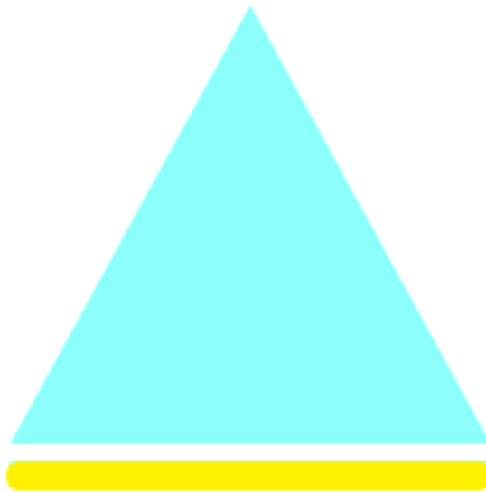
Рисунок 3.5.2. Конфигурация Отто, призма отмечена голубым, проводящая плёнка жёлтым, воздушный зазор между ними.
