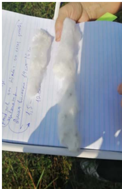
Şəkil 4. Adi pambıq çiyidindən əldə olunan pambıq lifi (qısa olan) və impuls qaz boşalmasında emal olunmuş pambıq çiyidindən alınan pambıq lifi (uzun olan).
