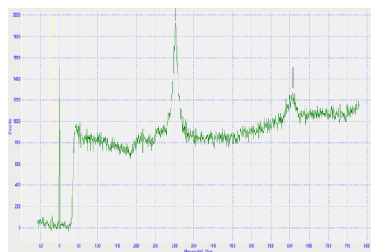
Рис.5 Спектр рамановского рассеяния пленок CdS
