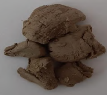
Şəkil 2. Hammer metodu ilə sintez edilmiş azlaylı qrafen oksidin fotosəkili göstərilmişdir.
