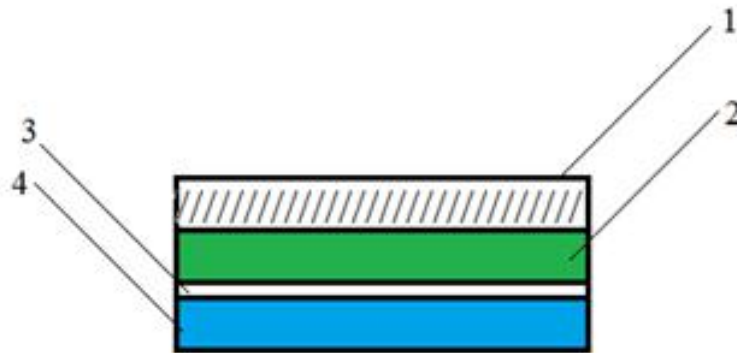
Şəkil 7. İnformasiyanı oxuyan başlıqda maqnit "sendviçi": 1 – fiksə edən təbəqə; 2, 4 – yumşaq maqnit təbəqələri; 3 – qeyri-maqnit təbəqə.
