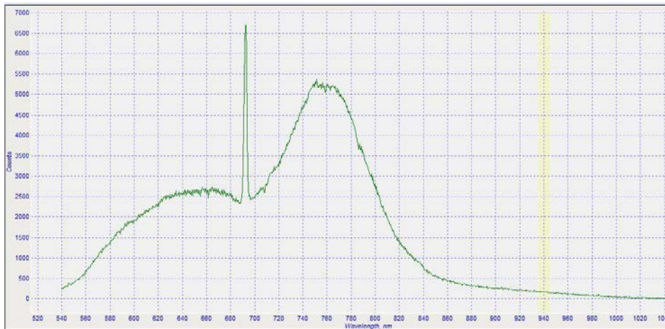
Şəkil 3. CuInS 2 monokristalının lüminessensiya spektri alınması.
