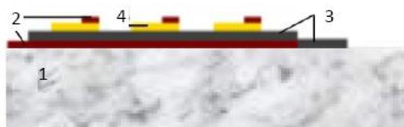
Рис.1. Тонкопленочная гетероструктура  $\text{Mo/p-Cu}_2\text{ZnSnSe}_4/\text{n-CdS/Mo}$ , где: 1- подложка из стекла, 2- контактный материал из Mo, 3- пленка из  $\text{p-Cu}_2\text{ZnSnSe}_4$ , 4- пленка из  $\text{n-CdS}$
