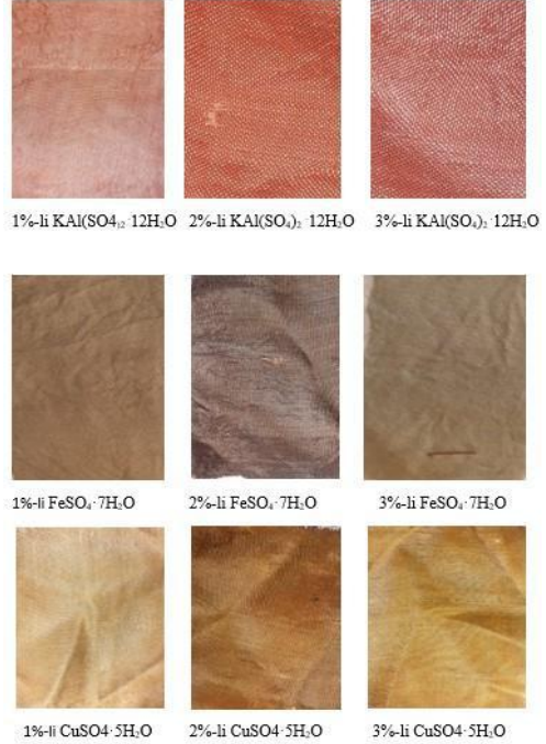
Şəkil 4. Boyanmış ipəyin müxtəlif konsentrasiyalı duzlarda fiksasiyasından alınan rəng çalarları.
