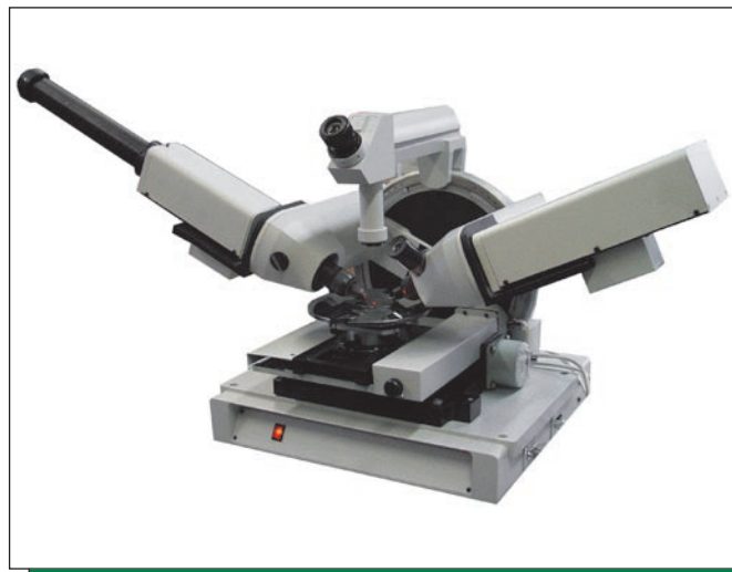
РИСУНОК 5 | Сканирующий лазерный эллипсометр МИКРОСКАН позволяет проводить локальные измерения и осуществлять картирование свойств поверхности по площади образца
